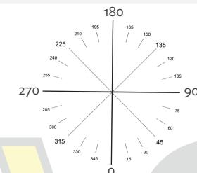
De flexibel wordt bekeken volgens de richting "A". De draaihoek wordt uitgedrukt in graden ( $^{\circ}$ ) en kan maximum oplopen tot een waarde van  $360^{\circ}$ , zie figuur. **OPGELET**, bij een verdraaiing in de verkeerde richting wordt een verkeerde assemblage bekomen!
